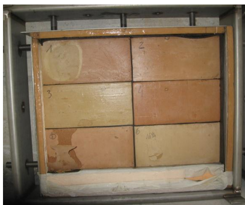
Figura 3: Pannello sottoposto a prova al termine dei cicli di gelo/disgelo
